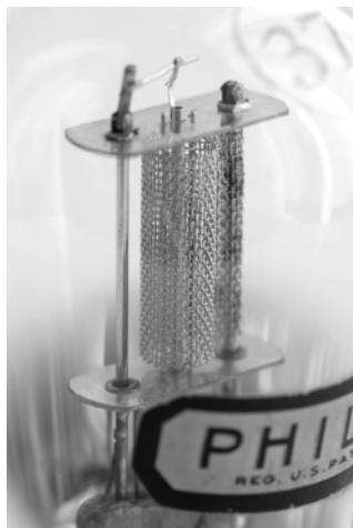
Рис. 2.48 Внешний вид «плетенного анода» лампы Philco 37
