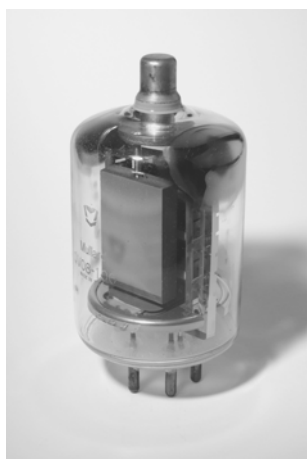
Рис. 2.50 Графитовые анодные пластины тетрода QV08-100
