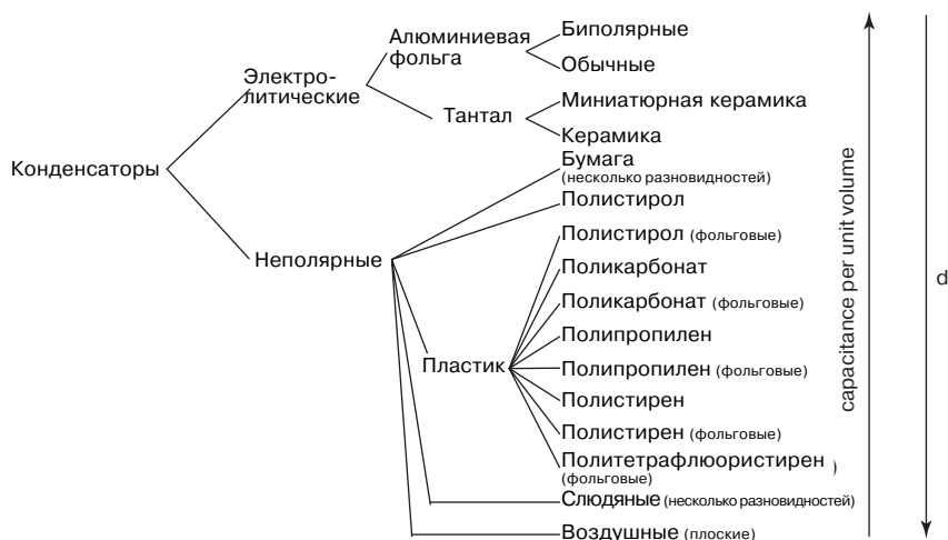
Рис. 5.4 Разновидности конденсаторов
