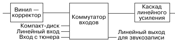
Рис. 8.1 Структурная схема предусилительного каскада
